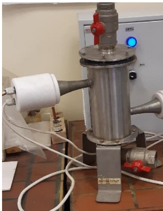
Рисунок 1. Опытная установка низкочастотного ультразвука.
