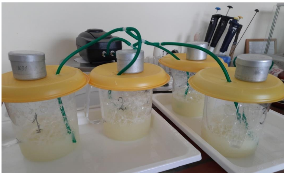
Рисунок 2. Лабораторная установка с мини-биореакторами.
